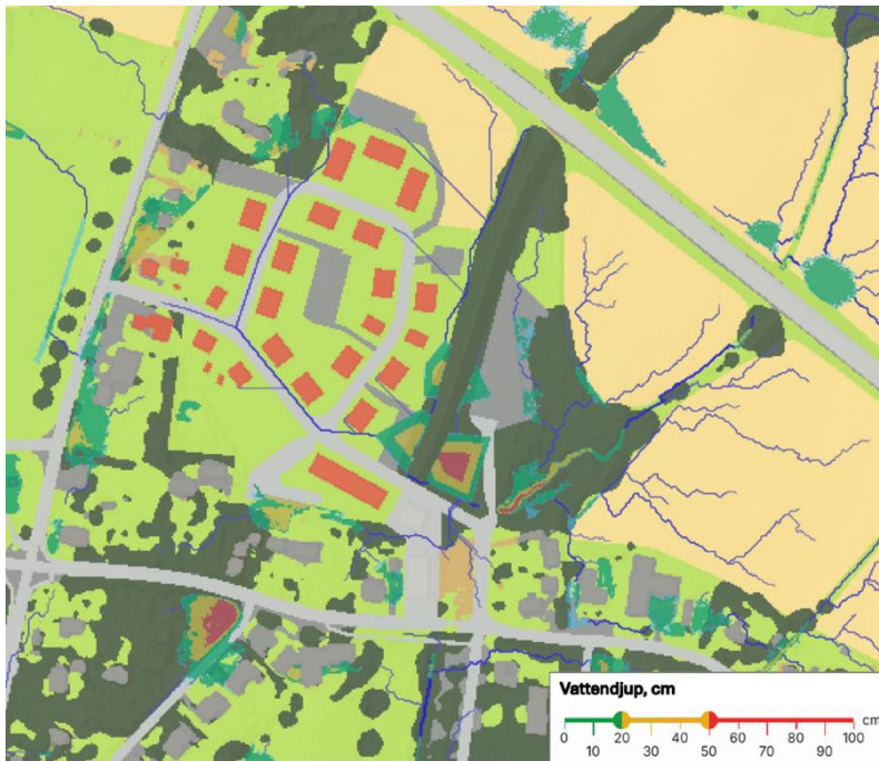
Figur 18. Resultat från skyfallssimuleringen. Gula ytor visar vattendjup på mellan 20 och 50 centimeter. Från Norconsults bemötande.
