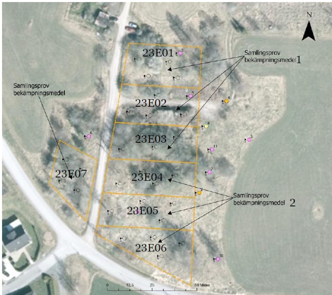
Figur 10. Provpunktspacering och provpunktsmärkning för provtagning i januari 2023. Från Översiktlig miljöteknisk markundersökning avseende fastigheterna Skaraberg 3:1, 3:3, 3:6, 3:9, 3:10, 3:11 m.fl., 2023-02-17 .
