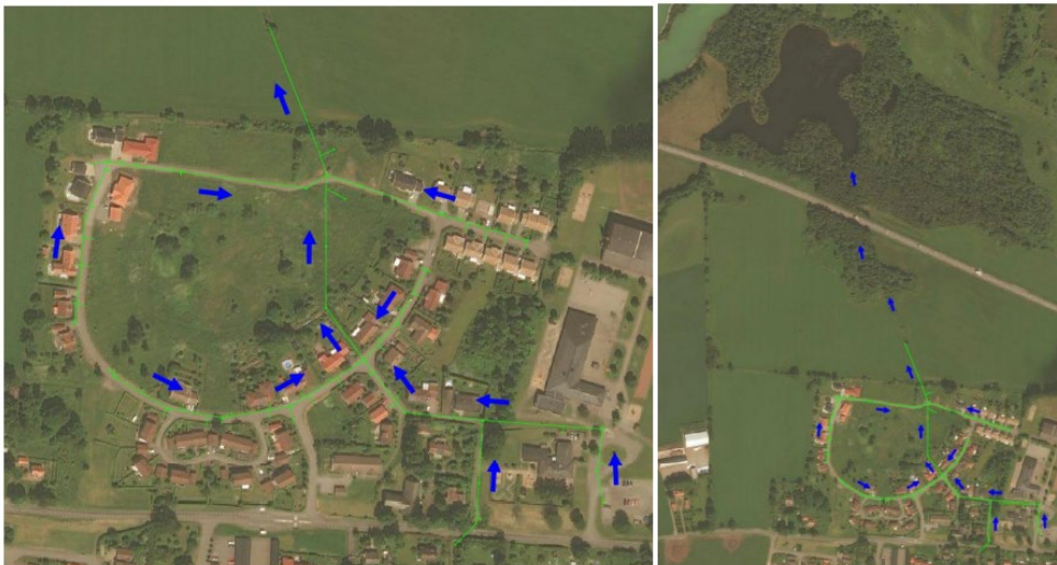
Figur 26. Befintlig avvattning inom planområdet.
