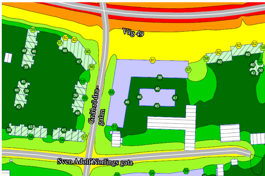
Ekvivalent ljudnivå 2040. Ljudnivå beräknad 2 m ovan mark från vägtrafik. Ljudnivå vid fasad avser högsta beräknade värde oavsett våningsplan.
