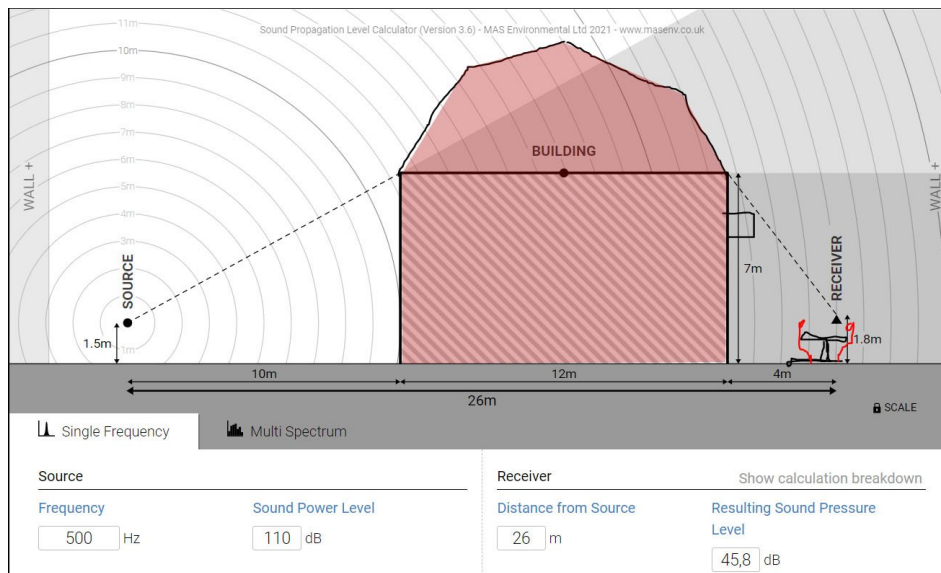
Figur 4 - Bedömningen efter analys av byggnadens potentiella bullerskydd är att tyst sida kan få låga bullervärden på 46 dBA** (26 m från vägens mitt) även vad gäller maxvärdet för buller som vid fasad är 82 dBA*.
