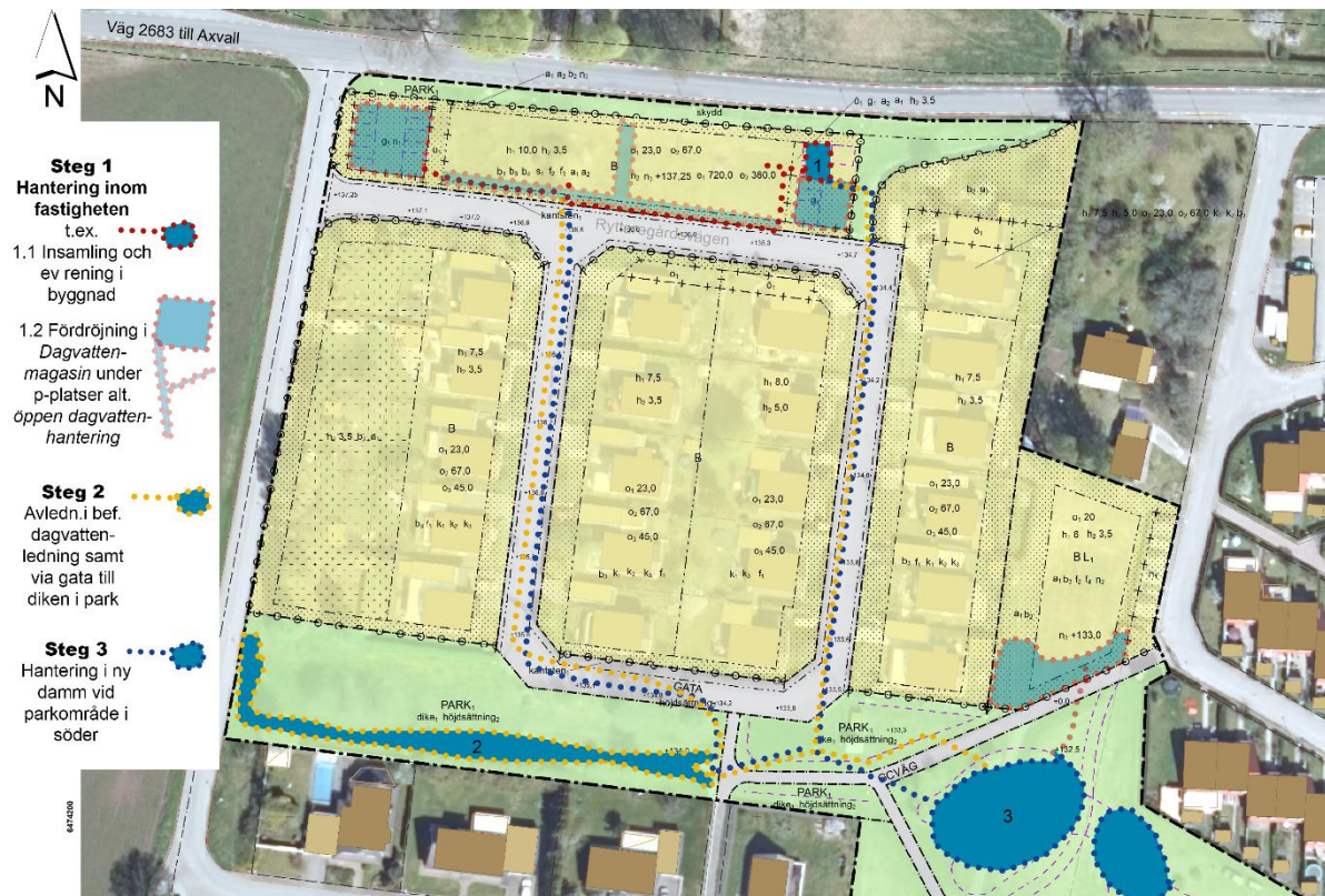
Figur 2 - Illustration över tre lösningar för dagvattenavledning och hantering för nya bostäder som tillsammans kan lösa utmaningen på ett tillfredställande sätt.
